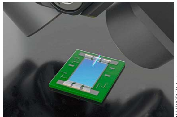
Der einzelne Microchip muss elektrisch und fehlerfrei mit dem Gehäuse oder der Platine per Drahtbonden oder Flip-Chip verbunden werden.
